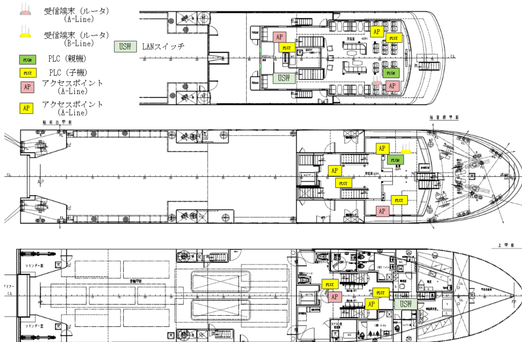
【 図 3B-2 LAN ケーブル方式 パターン B 機器配置図】
