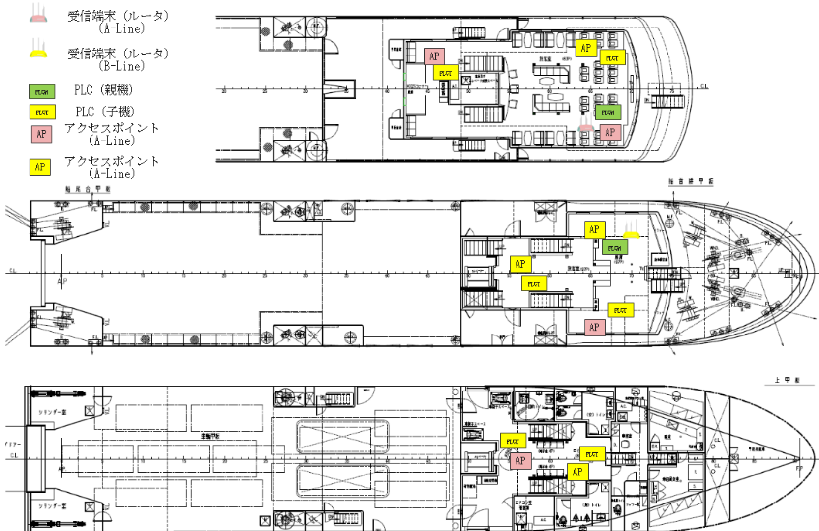
【 図 3C-2 電力線通信方式 パターン C 機器配置図】
