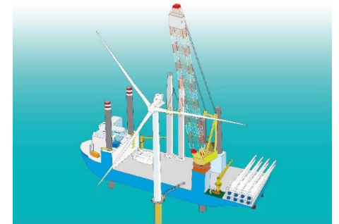
専用船利用の洋上風力発電設備の建設工事
