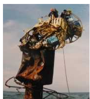
損傷した浮体式灯標
